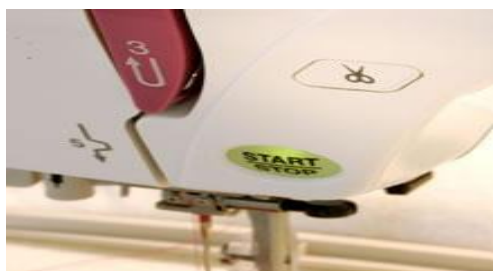
Расми 2.24. Функсияи автоматии буридани ришта
